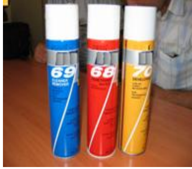
Resim 1.1: Penetran testinde kullanılan soldan sağı doğru temizleyici spreyl, penetran spreyl ve geliştirici spreyl
